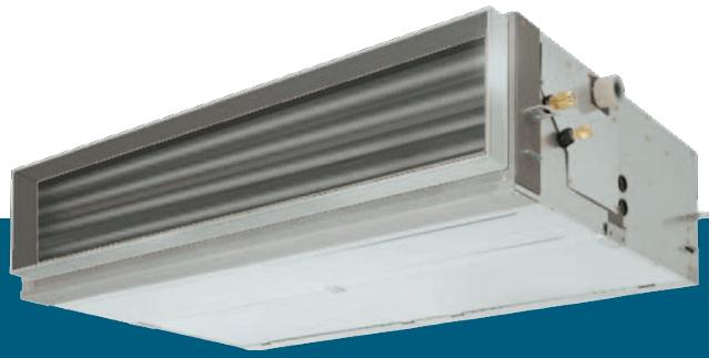
Standard-Kanalgerät für RAV Ein-Raumsysteme zur Kombination mit Digital-, Super-Digital- und Digital Inverter BIG-Außengeräten für Kältemittel R32 oder R410A. Die Luft kann diskret mit geringster Geschwindigkeit über einen oder mehrere Luftauslässe in den Raum geleitet werden. Verfügbar in vier Leistungsabstufungen von 5,0 bis 12,5 kW.
